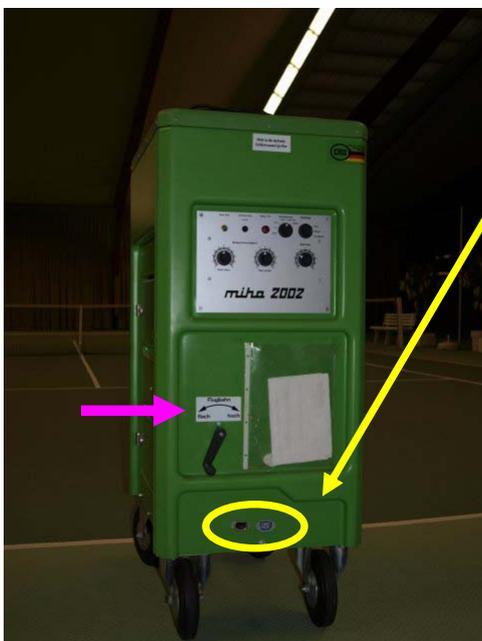
Die Anschlüsse für das Netz- und das Fernbedienungskabel befinden sich hier
